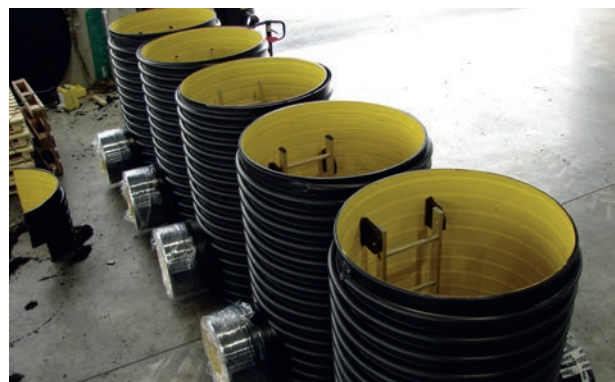
Regnvandsbrønde med el-svejsede samlinger.
