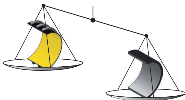
Korrugerede rør har de samme statiske egenskaber som massive rør. Det betyder, at brug af korrugerede rør muliggør en reducere af rørvægten på op til 65%.
