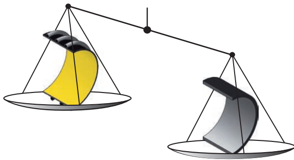
Struktuuriset putket ovat jopa 65 % kevyempiä, verrattuna samoilla staattisilla ominaisuuksilla varustettuihin monoliittisiin putkiin.
