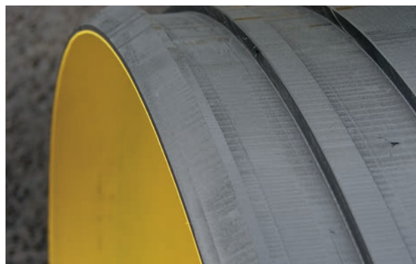
Rowki pod uszczelkę gumową na rurze
