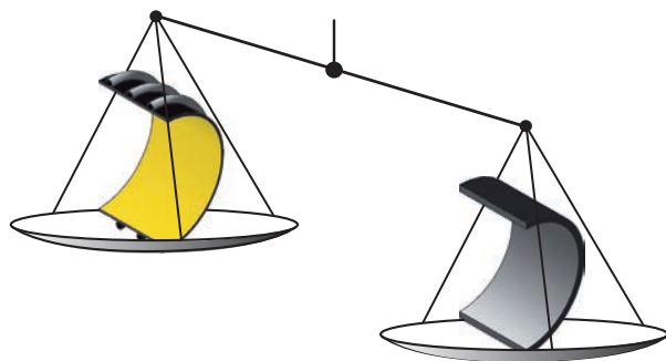
W porównaniu do rur o ściankach monolitycznych o podobnych właściwościach statycznych, stosowanie rur o ściankach strukturalnych pozwala zmniejszyć wagę rury do 65%.
