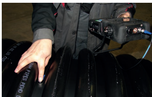
Pomiar grubości ścianki rury
