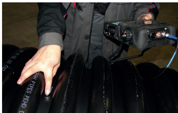
Mätning av rörens vägg tjocklek
