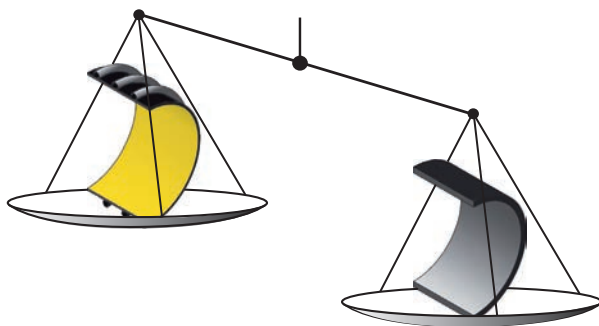
I jämförelse med massiva rör med likvärdiga statiska egenskaper kan användning av lättviktsrör minska rörens vikt med upp till 65%.
