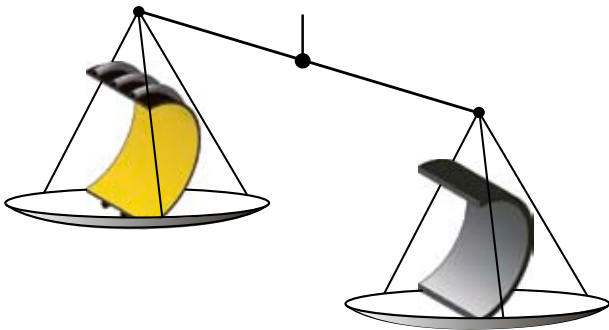
Võrreldes samade staatiliste omadustega monoliitsete torudega võimaldab struktuursete torude kasutamine vähendada torude kaalu kuni 65%.
